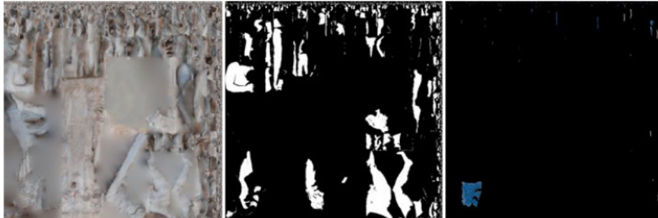
Figura 6 – Creazione di maschere per la sovrapposizione di più strati di colore: colore originale (sx), preparazione della maschera (centro); maschera di colore blu (dx).
